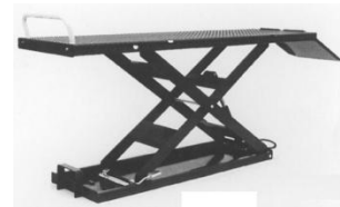
Saksinostin (moottoripyöränostin), kuormauselimenä on ajosilta. Tämä nostin on rakenteeltaan sel- lainen, että kuorman alle ei mennä.
