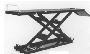
Saksinostin (moottoripyöränostin), jossa kuormauselimenä on ajosilta. Tämä nostin on rakenteeltaan sellainen, että kuorman alle ei mennä.
